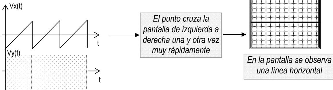
Esta señal triangular viene con el osciloscopio: “Base de Tiempo”
