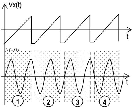
*En la pantalla se observa la superposición de las pantallas 1,2,3,4,... y el resultado no es el esperado*
